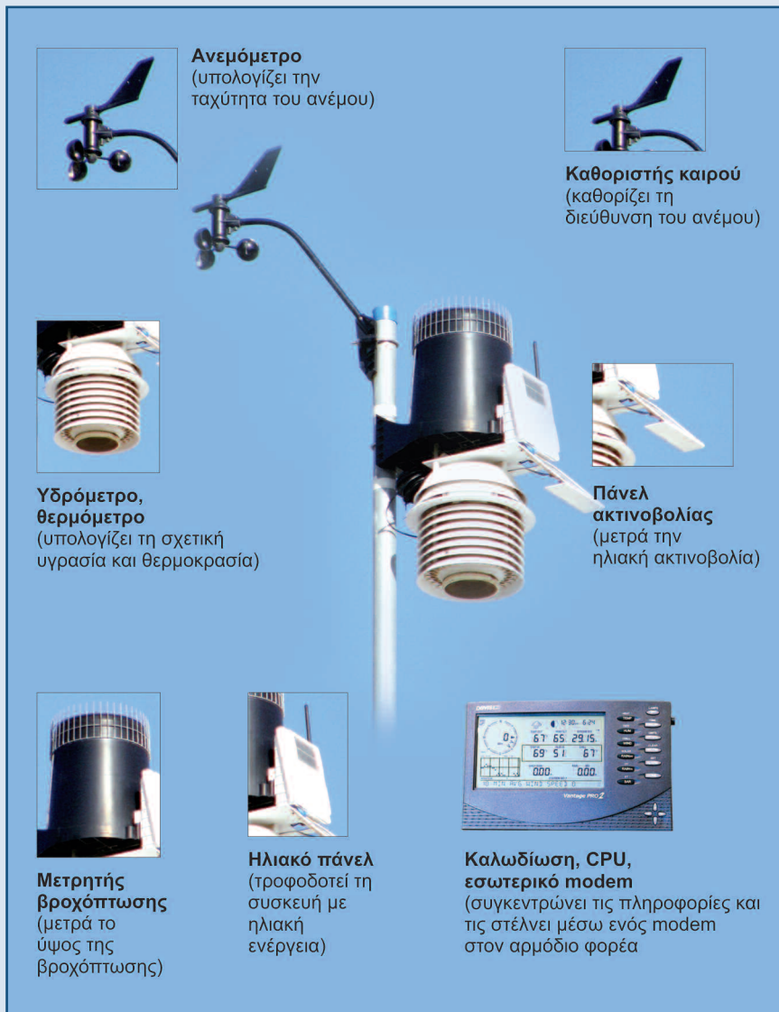
Σχήμα 15. Τυποποιημένος εξοπλισμός σε μετεωρολογικό σταθμό. Φώτο Μ. Δρετάκης
