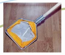
Fig. 2. Hand net sampler.
